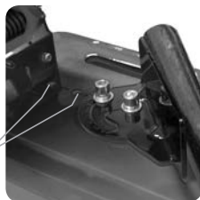
Orificios de posicionamiento de la base para cortes angulares.
