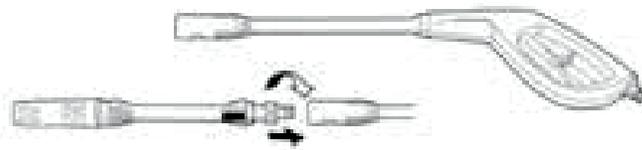
**3** Instale la manguera de alta presión a la pistola por medio de una llave 17 mm o una llave ajustable no incluidas con él equipo.
