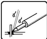
3. Coloque soldadura a base de resina a la parte que calentó previamente, enseguida aplique el cautín para derretir la soldadura. **NOTA:** Cuando use una soldadura que no contenga base de resina, asegúrese de aplicar una pasta de soldadura a la parte pre-calentada antes de colocar el cautín.
