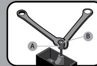
Atornille la tuerca extractora en el espárrago a retirar y apriete utilizando dos llaves (A y B).
