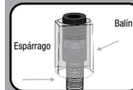
Atornille la tuerca instaladora en el espárrago hasta que el balín haga contacto sobre el mismo. Atornille el espárrago sobrante en la rosca final.
