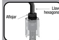
Para liberar la tuerca instaladora utilice la llave hexagonal L y afloje el opresor superior. Retire la tuerca instaladora del espárrago.
